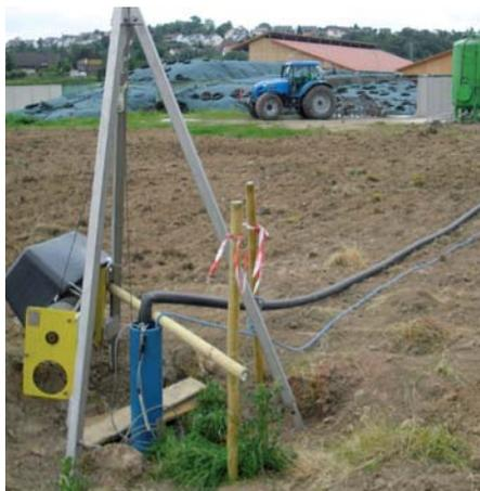
**Immissionspumpversuch im Bereich der Schadstofffahne**
