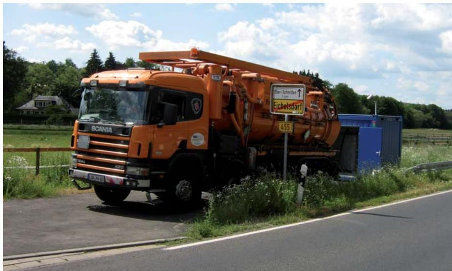
**Absaugung von Teeröl aus dem Gefahrstofftank im Container der Schadstoffrückgewinnung**
