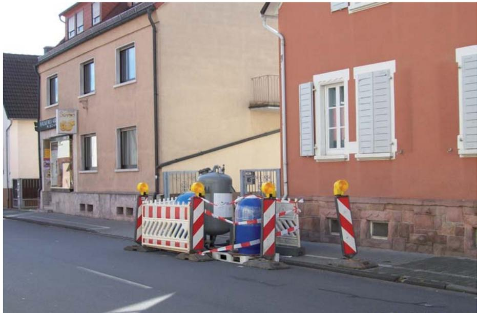
Wasserreinigung während eines Pumpversuches
