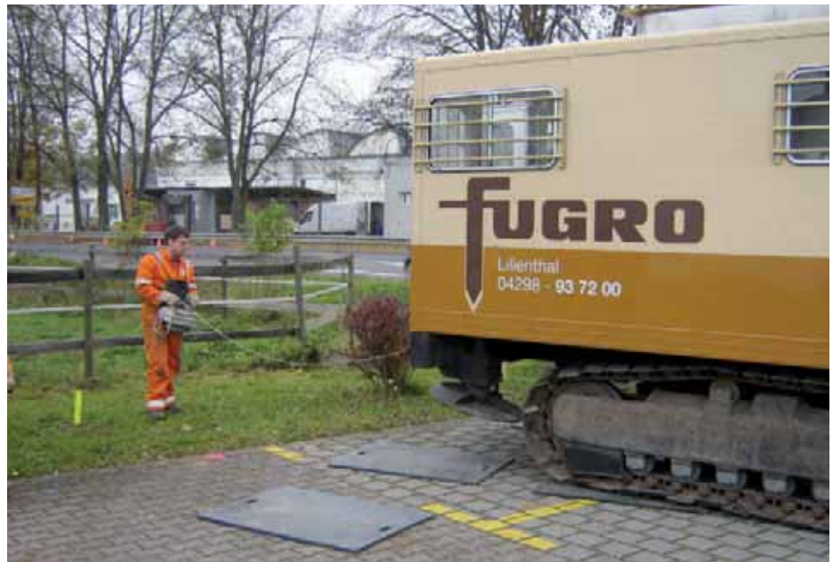
Einrichtung des Sondierfahrzeugs mit der ROST-Sonde zur Detektion von PAK im Untergrund
