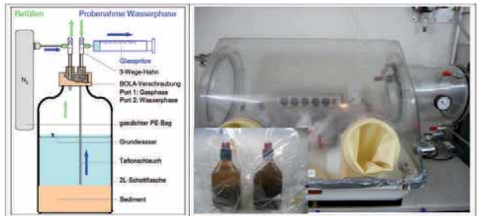
Aufbau eines Batchversuches und Umsetzung im Labor
