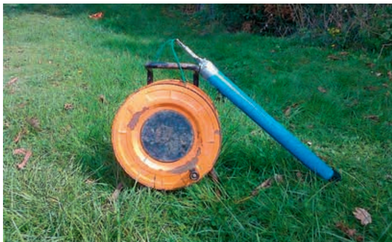
Fluid-Logging: Kartusche zum Aufsalzen der Filterstrecke einer Grundwassermessstelle
