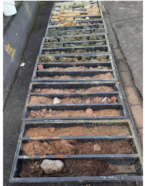
Bohrkern durch beide GW-Leiter (Quartär – vulkanisches/basaltisches Tertiär und sedimentäres Tertiär)
