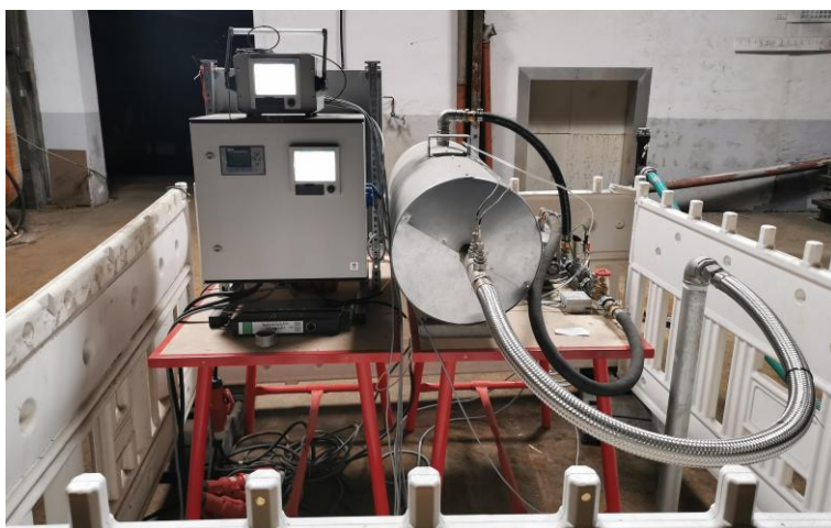
Versuchsanlage zur Einblasung erhitzter Frischluft
