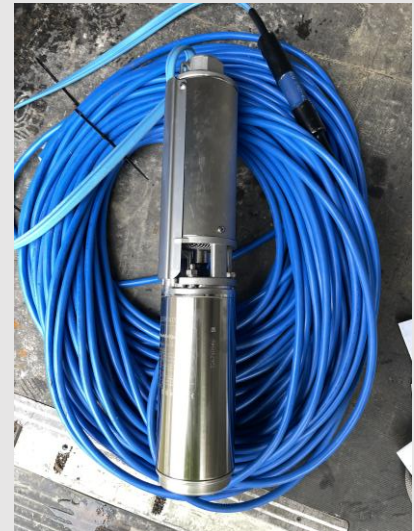
Neue Pumpe zur Förderung geringerer Wassermengen
