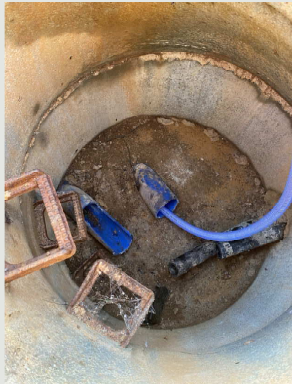
Infiltrationsvorgang am Horizontalbrunnen
