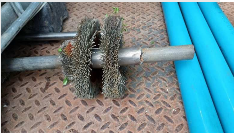
Brunnenregenerierung mittels mechanischer Reinigung
