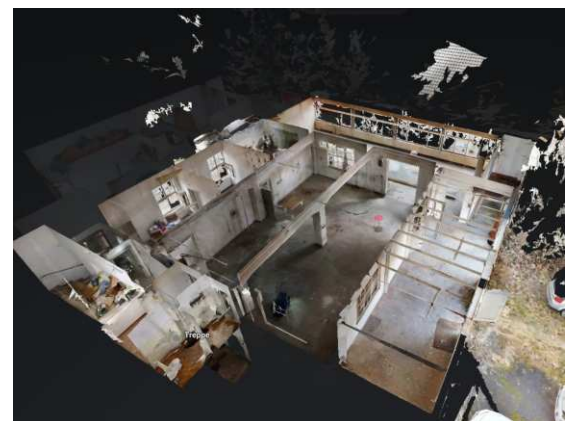
3D-Visualisierung Altgebäude 253 aus Laserscanning
