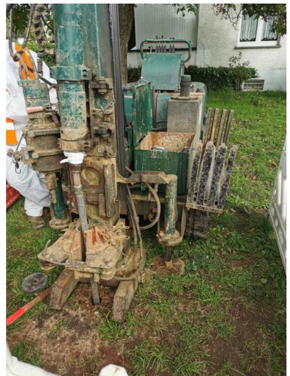
Bohrgerät zur Direct-Push-Sondierung
