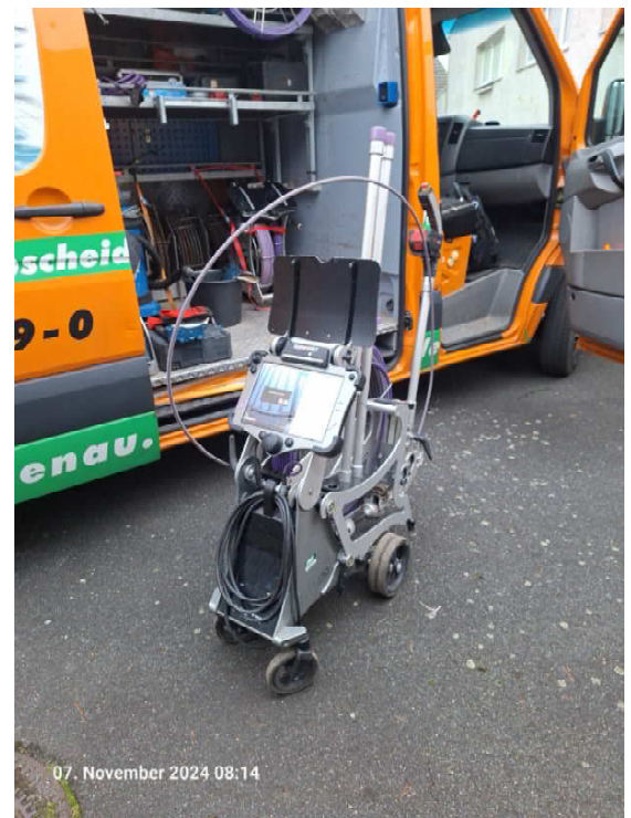
Kamerabefahrung der Drainagen
