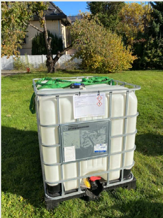
IBC mit Wasserstoffperoxid-Lösung
