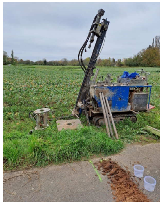
Probenahme für Säulenversuch
