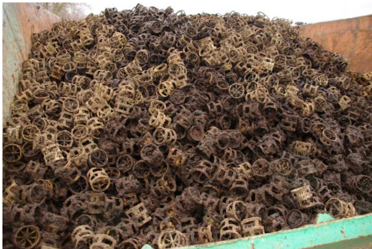
Austausch der zugesetzten Füllkörper der Strippanlage
