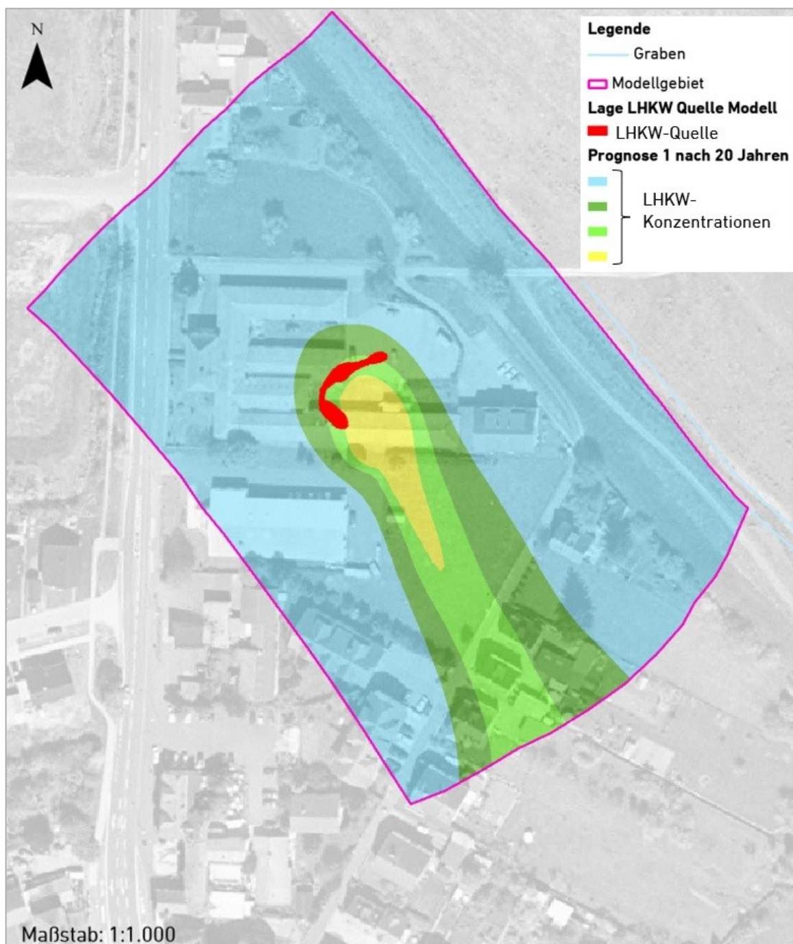
Prognoseberechnung LHKW-Fahne mit hydraulischer Sicherung im sandig-kiesigen Grundwasserleiter
