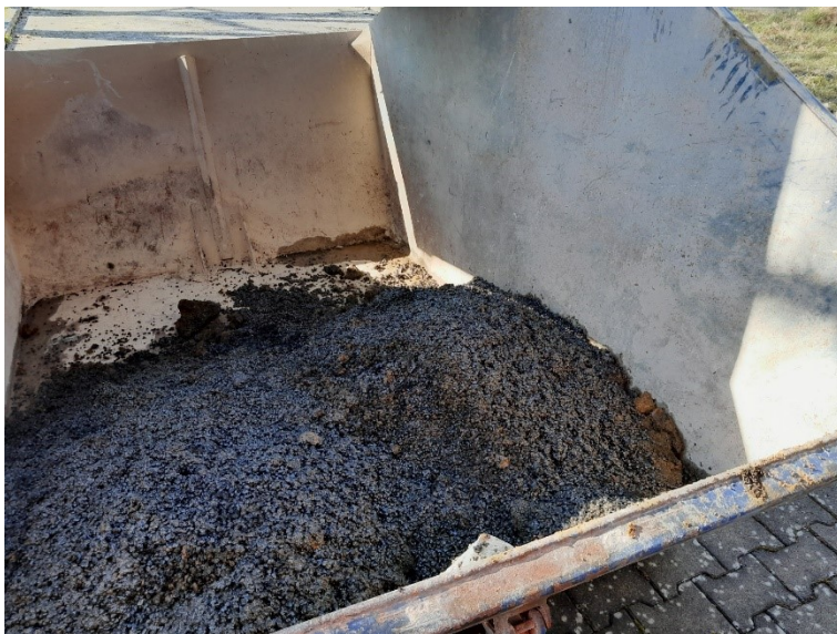
Teerölkontaminierter Filterkies nach Wechsel
