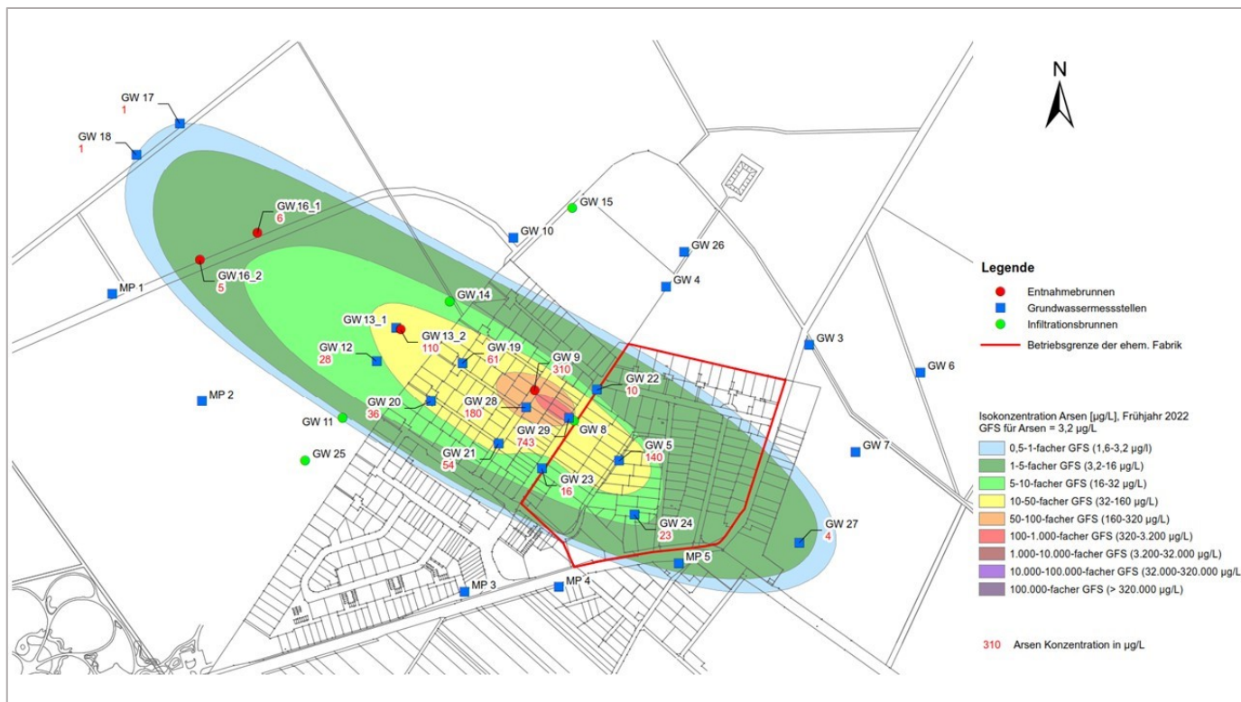
Räumliche Schadstoffverteilung von Arsen, Stand Frühjahr 2022
