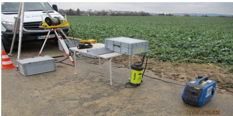
Messung mit Thermoflowmeter an einer Grundwassermessstelle
