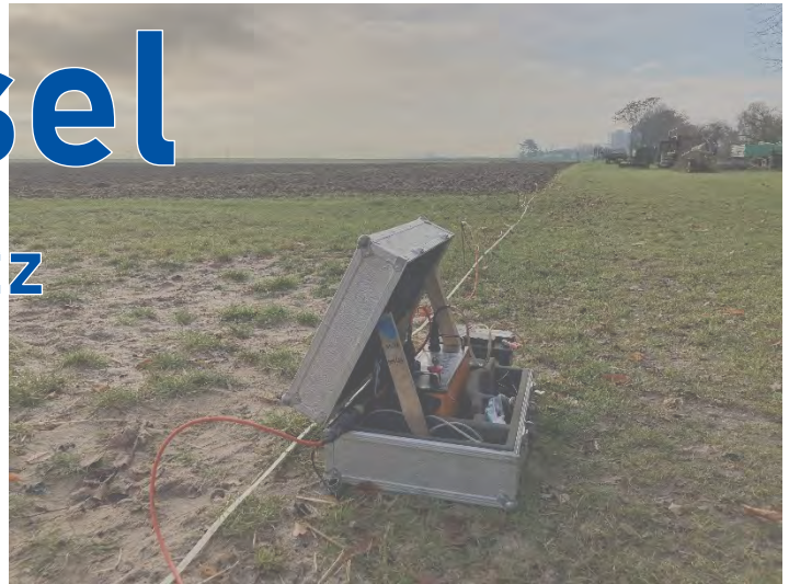
Geophysikalische Messungen mittels geoelektrischer 2D-Widerstandstomografie
