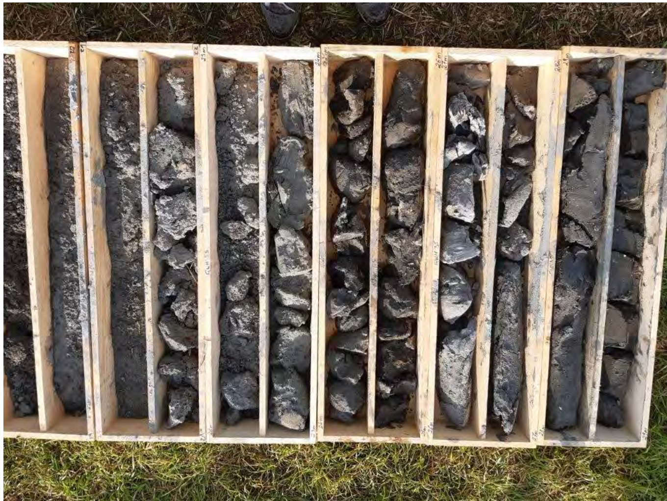
Bohrkerne für Bodenansprache
