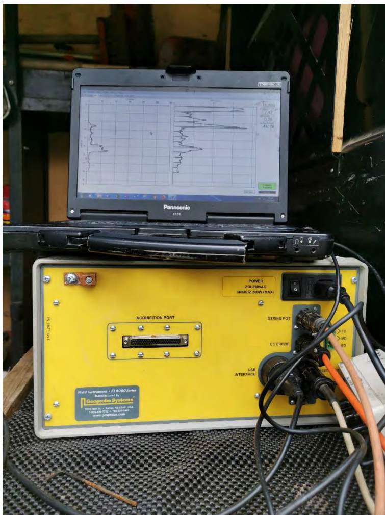
Aufnahme der vorhandenen geologischen Schichten mit Online-Messungen
