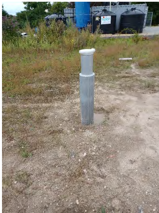
Neu errichtete Grundwassermessstelle
