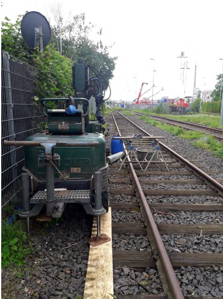
DP-Sondierungen im Bereich der Hafensbahntrasse
