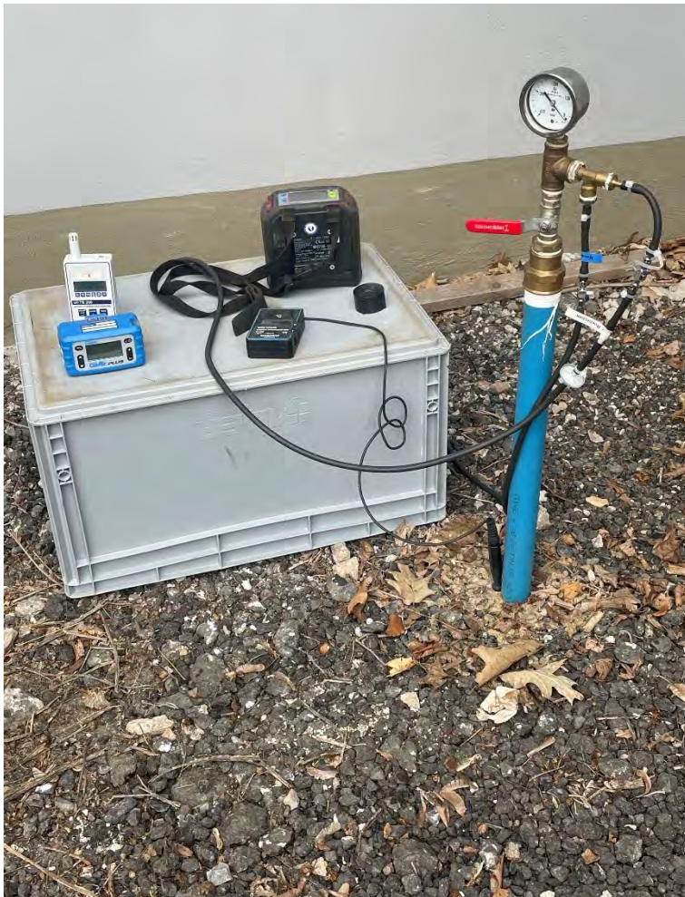
Durchführung einer Bodenluftmessung am Standort
