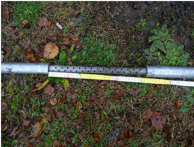
Injektionslanze zum Einbringen der Wirksubstanzen 1
