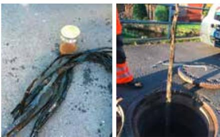
**Probenahme von dem Aufwuchsstreifen anhaftender Sielhaut/Biofilm aus der Abwasserkanalisation**
