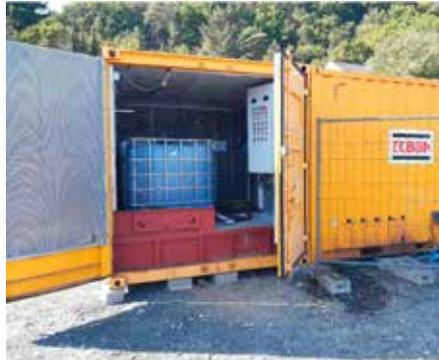
**Gefahrstoff- und Steuerungscontainer der ISCO-Sanierung**
