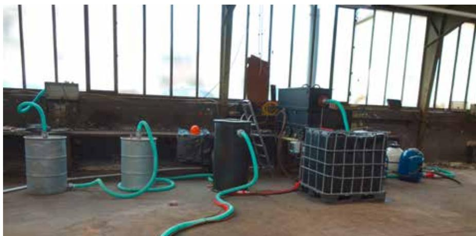
Versuchsaufbau (Bodenluft- & Grundwasserreinigung) in einer Werkhalle
