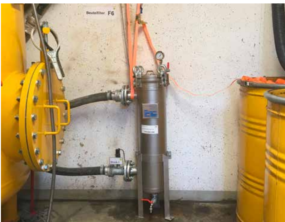
Versuch mit einem Beutelfilter zur Abtrennung von Feinkornmaterial
