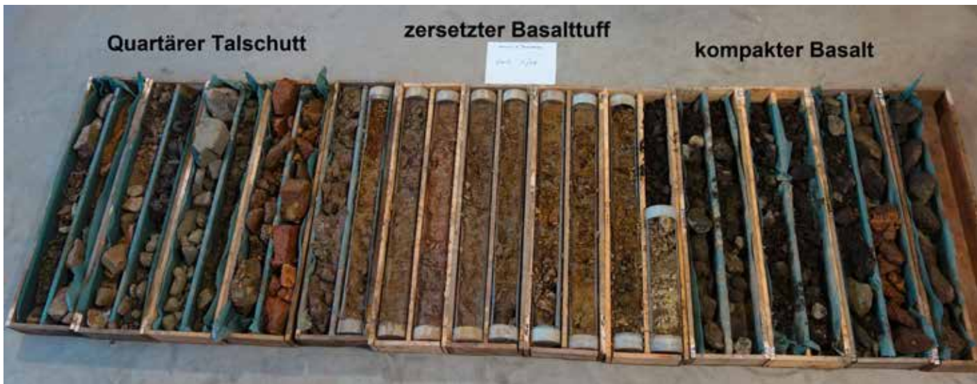
Bohrkerne der 25 m tiefen Tertiär-Messstelle
