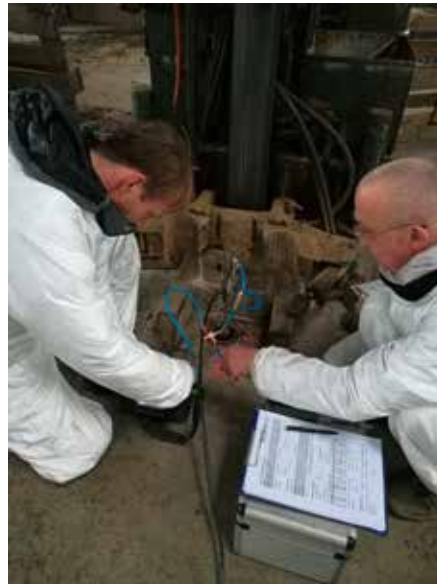
Bodenluftprobenahme während der Erkundungsarbeiten
