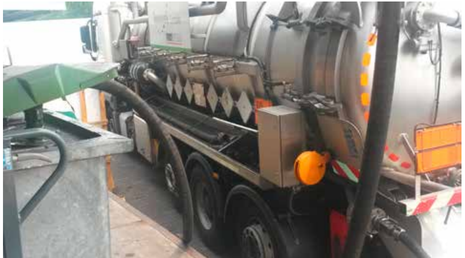
Ölabsaugung aus Ölsammelbehälter
