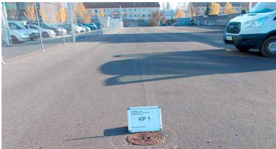
Fotodokumentation der Verkehrssicherheit von Grundwassermessstellen
