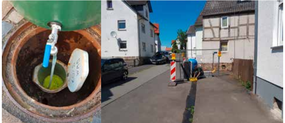
Markierungsversuch (Uranin), Eingabestelle GWM 5 und Pumpbrunnen GWM 14u
