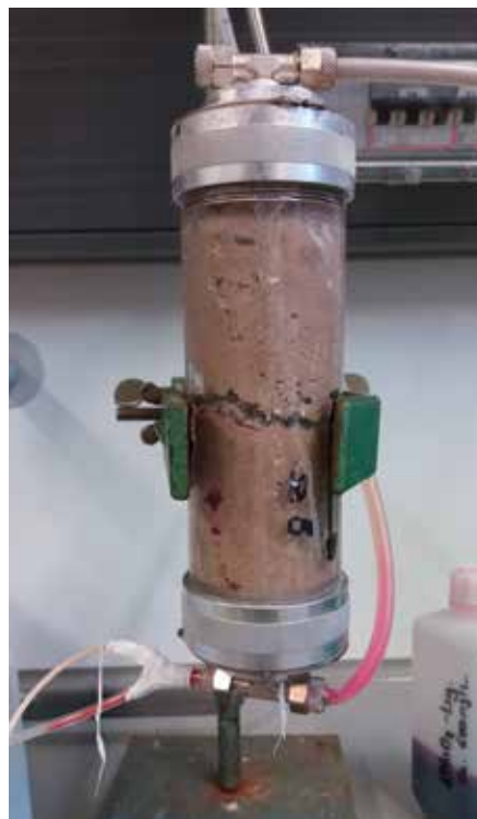
Braunsteinbildung bei Säulenversuch zu LHKW-Abbau mit Kaliumpermanganat
