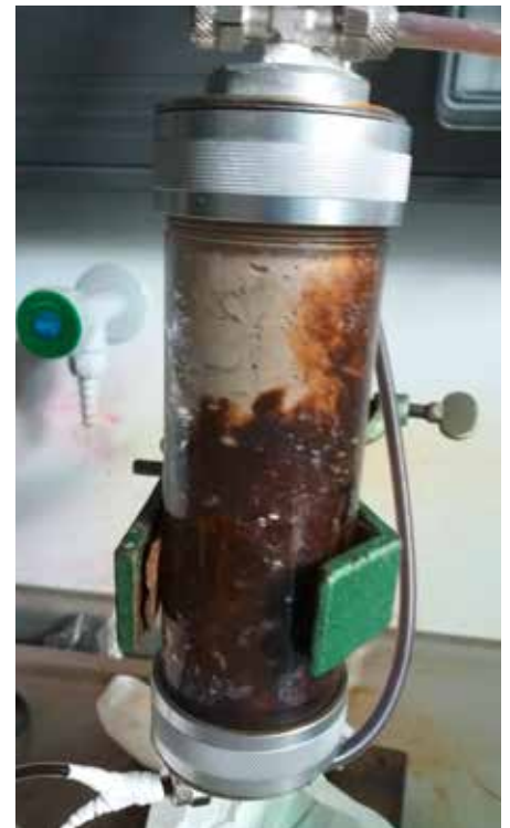
Braunsteinbildung bei Säulenversuch zu LHKW-Abbau mit Kaliumpermanganat
