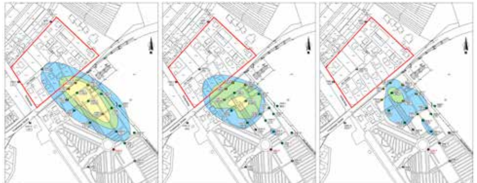
Sanierung der Schadstofffahne durch Enhanced Anaerob Biodegradation (EAB)
