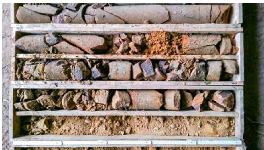
Bohrung KB 17: Zersatzzone der Grauwacke im Bereich 4-9 m u. GOK
