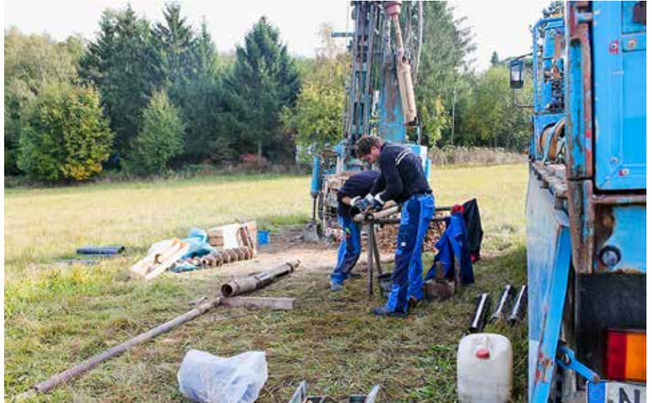
Entnahme von Liner-Bodenproben für ISCO-Laborversuche
