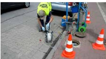
**Grundwasserprobenahme mittels Low-Flow-Verfahren**
